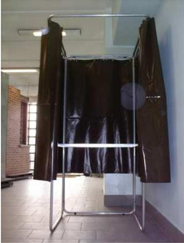
Interamente realizzata in tubo di acciaio zincato diametro 20, delle dimensioni indicative di mm. 860x860xh1920, con pianale scrittoio delle dimensioni di circa mm. 760x330, che può essere previsto regolabile per portatori di handicap. Il telo è realizzato in PVC autoestinguente e si estende per tutto il perimetro della cabina per un'altezza di circa mm. 1200.
